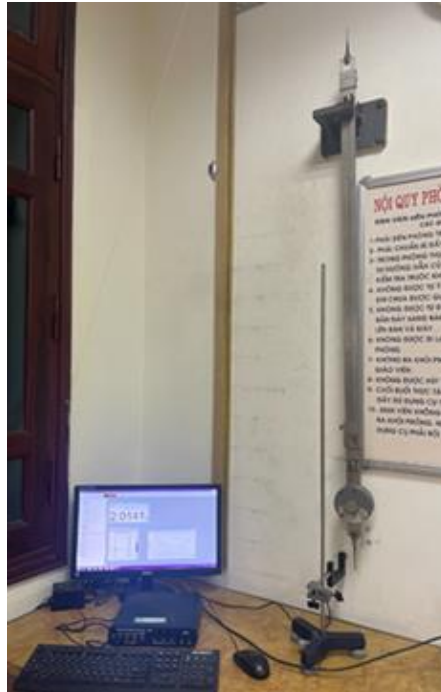
Hình 8. Bố trí thí nghiệm xác định gia tốc trọng trường thông qua chu kỳ dao động của con lắc
